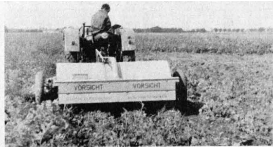
Foto: Jordan Dreireihiger Krautschläger der Landmaschinenfabrik Essen
